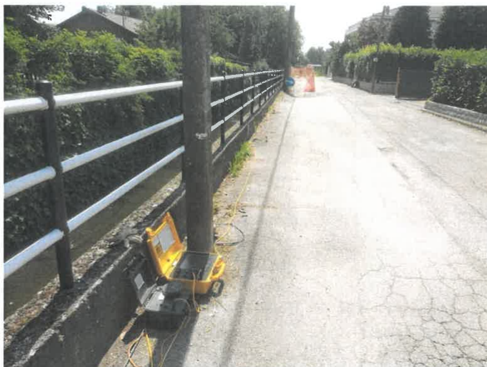
Foto 3-4 Area in esame con attrezzatura utilizzata per l'esecuzione delle prove penetrometriche e stendimento sismico di tipo MASW
