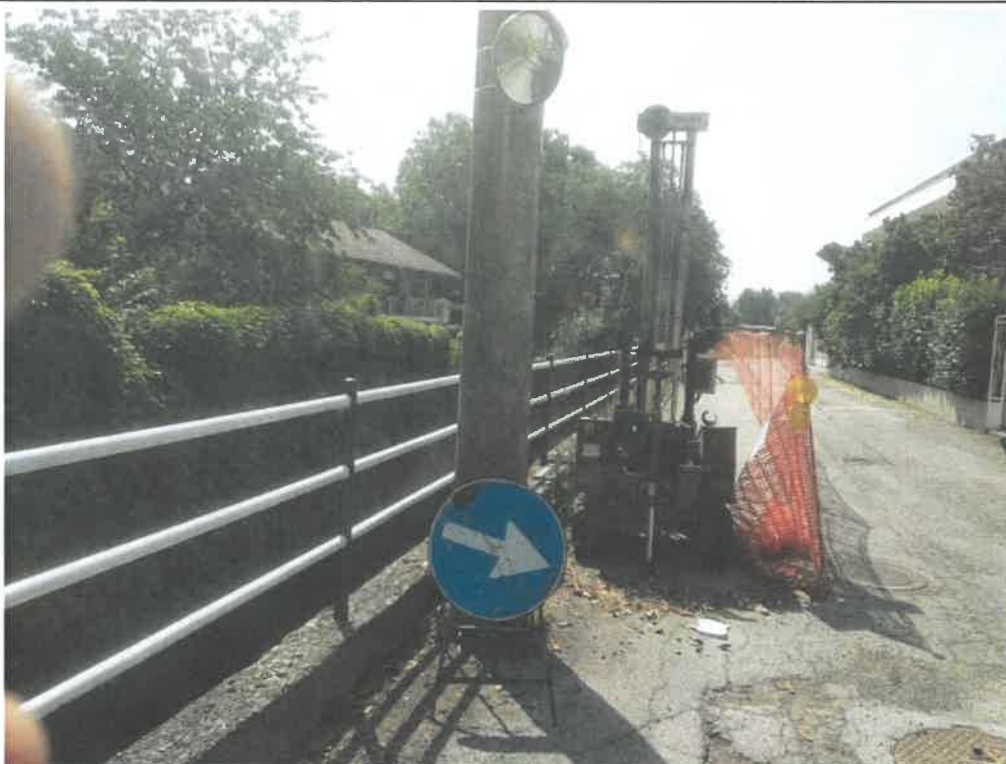
Foto 3-4 Area in esame con attrezzatura utilizzata per l'esecuzione delle prove penetrometriche e stendimento sismico di tipo MASW
