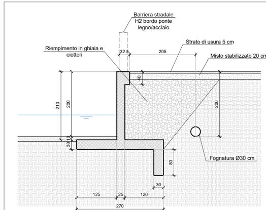
Sezione muro in progetto - Scala 1:50
